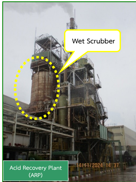
ภาพที่ 2.3 ระบบควบคุมมลสาร (Scrubber) ของ Acid Recovery Plant (ARP) และ Pickling Line (PL)
